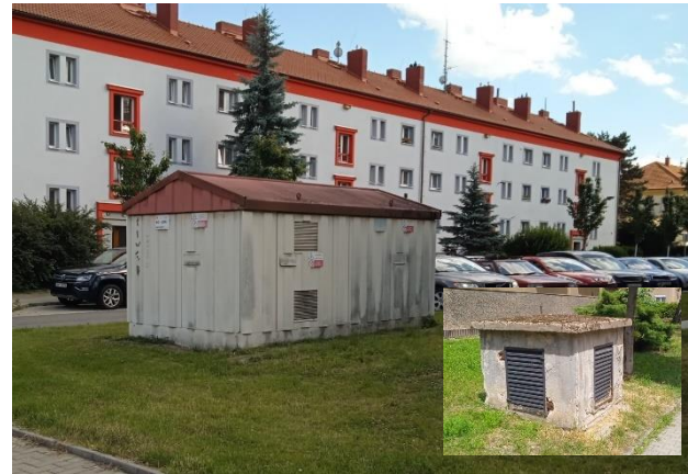
[6] nadzemní prvky technické infrastruktury – trafostanice, nouzový výstup z krytu civilní ochrany napojený na filtroventilaci
